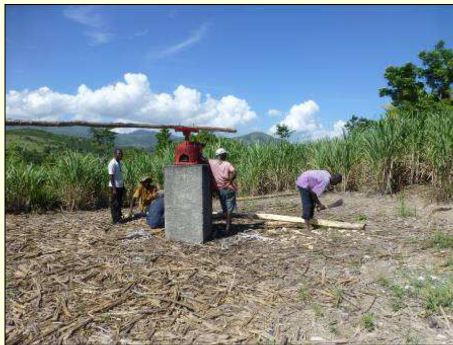
Moulin en fer à traction animale installé chez M. Anous CELONY en 2013
